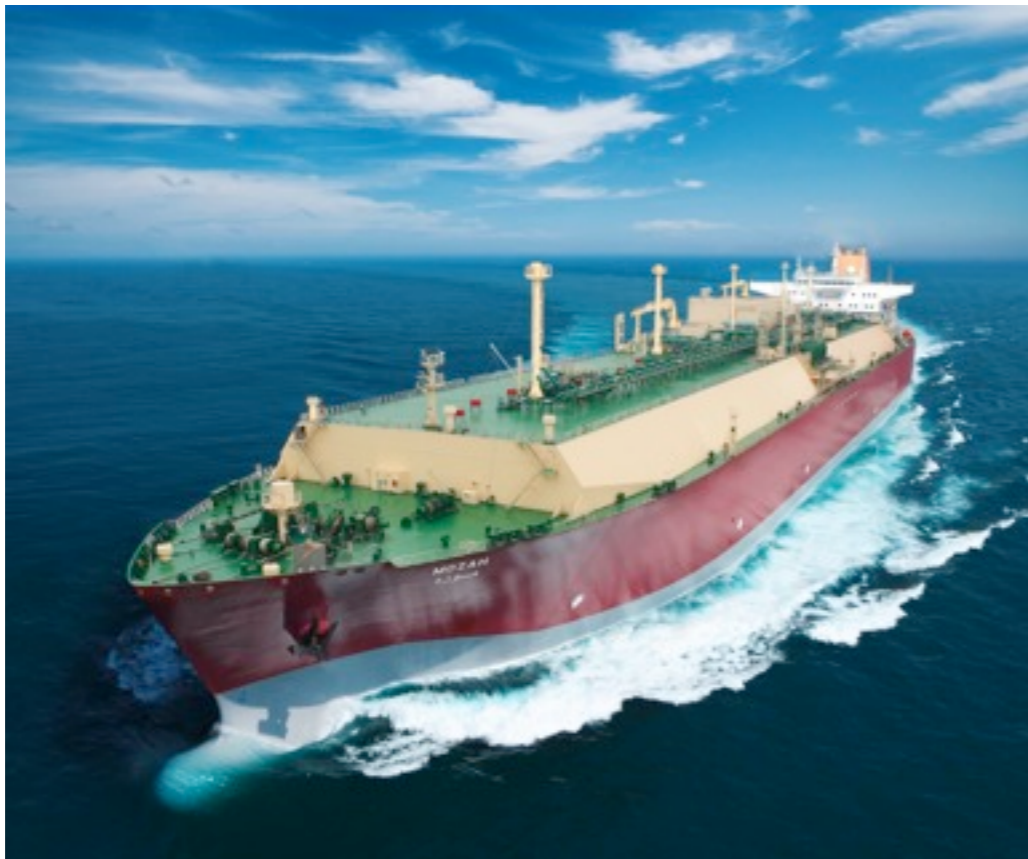
Q-Max LNG Carrier Capacity: 266,000m 3
