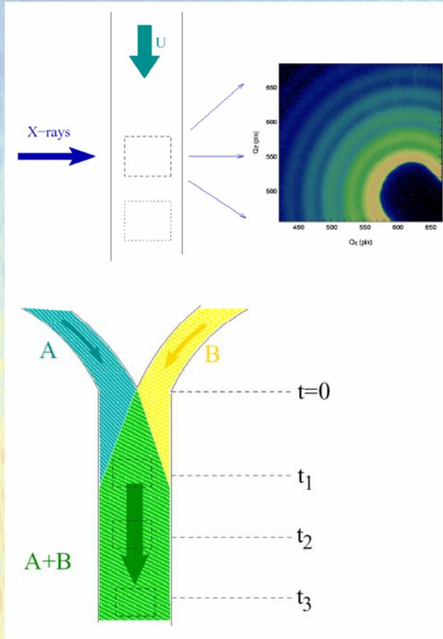
Flowcell: To avoid beam-damage.
