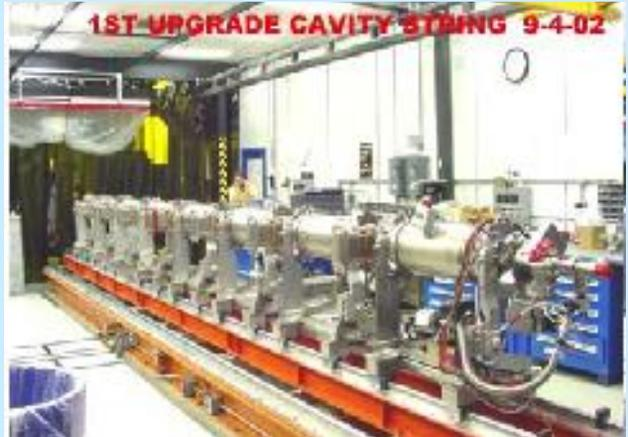
Cryomodule assembly at JLAB.
