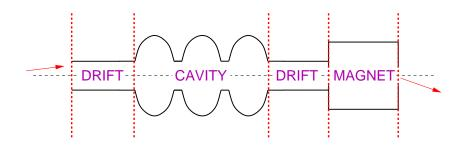
$$\begin{pmatrix} r \\ r' \end{pmatrix}_f = \begin{pmatrix} \mathsf{magnet} \\ \mathsf{matrix} \end{pmatrix} \begin{pmatrix} \mathsf{drift} \\ \mathsf{matrix} \end{pmatrix} \begin{pmatrix} \mathsf{cavity} \\ \mathsf{matrix} \end{pmatrix} \begin{pmatrix} \mathsf{drift} \\ \mathsf{matrix} \end{pmatrix} \begin{pmatrix} r \\ r' \end{pmatrix}_{i}$$
