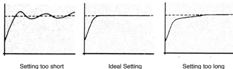
**Figure 5-6. Integral (Reset) Time**
