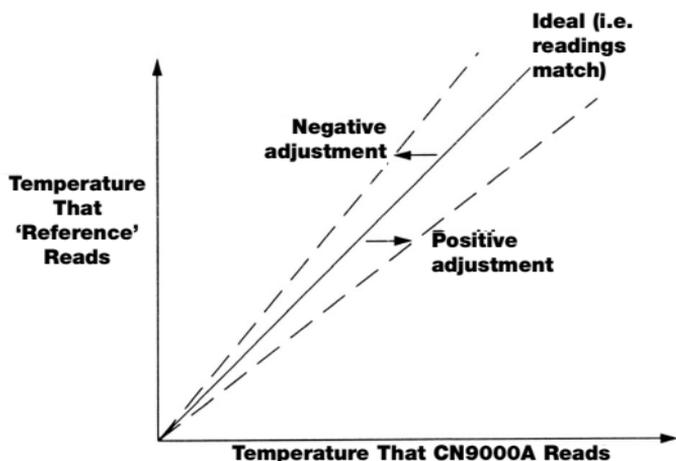
**Figure 6-2. Sensor Span Graph**
