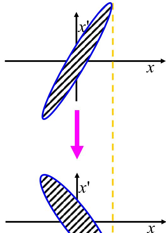
$$\begin{pmatrix} \beta & -\alpha \\ -\alpha & \gamma \end{pmatrix} = \begin{pmatrix} 1 & 0 \\ -k & 1 \end{pmatrix} \begin{pmatrix} \beta_0 & -\alpha_0 \\ -\alpha_0 & \gamma_0 \end{pmatrix} \begin{pmatrix} 1 & -k \\ 0 & 1 \end{pmatrix}$$
