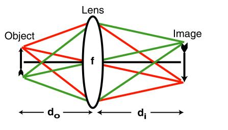
$$O = \begin{bmatrix} 1 & d_i \\ 0 & 1 \end{bmatrix} \begin{bmatrix} 1 & 0 \\ -1/f & 1 \end{bmatrix} \begin{bmatrix} 1 & d_o \\ 0 & 1 \end{bmatrix} \qquad B = d_o + d_i - d_o d_i / f = d_o d_i \begin{bmatrix} 1/d_o + 1/d_i - 1/f \end{bmatrix} = \begin{bmatrix} 1 & d_i \\ 0 & 1 \end{bmatrix} \begin{bmatrix} 1 & d_o \\ -1/f & 1 - d_o / f \end{bmatrix} \qquad O \text{ if } \begin{bmatrix} \frac{1}{d_o} + \frac{1}{d_i} = \frac{1}{f} \\ -1/f & 1 - d_o / f \end{bmatrix}$$
