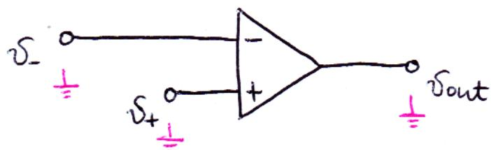
$$V_{out} = G(V_+ - V_-) + G_{cm} \frac{V_+ + V_-}{2}$$
