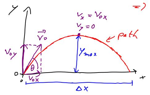
$$\overline{V_o} = V_{ox} \overline{C} + V_{oy} \overline{f}$$
